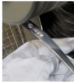
⑥バフと言われるやすりを使用し、手磨きで荒く研磨していきます。
