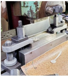
⑤押し型を使ってプレスして丸い膨らみを持たせます。
