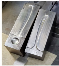
③専用の金属押し型を製作します。
