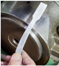
①純銀板をスプーンの形状に荒抜きします。
