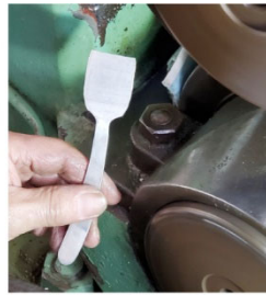
②荒抜きした純銀板をロール状に伸ばします。
