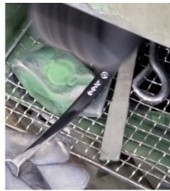
⑦仕上げ用の細かいバフを使用し、手磨きで丁寧に仕上げられています。
