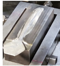
④押し型を使ってハンドルの厚み・カーブ・刻印部分をプレスします。
